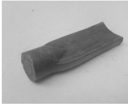
Рис. 4. Ескіз в перерізі філь'ери для отримання прямокутного профілю (а), zdeформована заготовка на проміжній стадії (б) та кінцевій стадії видавлювання.
