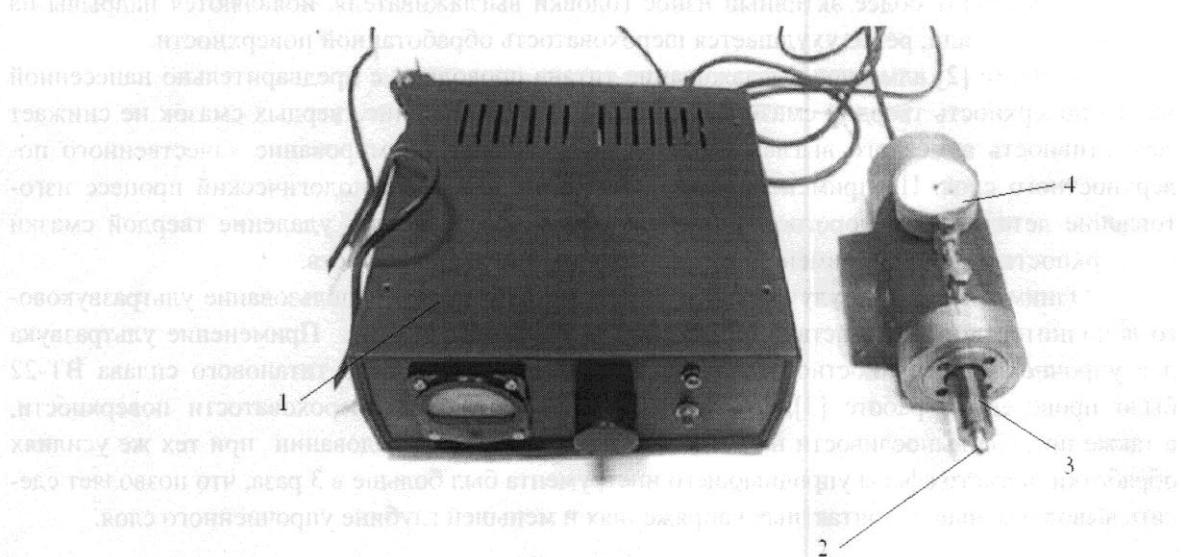
Рис. 1. Установка для выглаживания с дополнительным ультразвуковым нагружением
