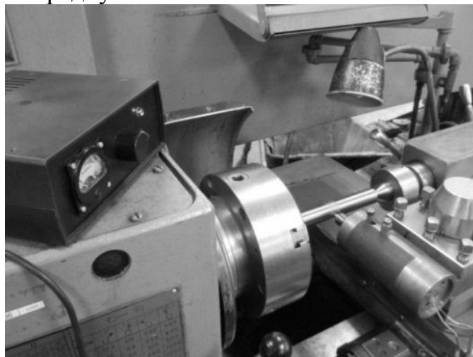
Рисунок 1 – Установка для УЗ выглаживания на токарном станке Технологические режимы процесса обработки представлены в табл.1.
