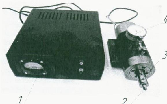
Рис. 1. Установка для УЗ выглаживания
