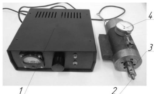
**Рис. 1. Установка для УЗ выглаживания**
