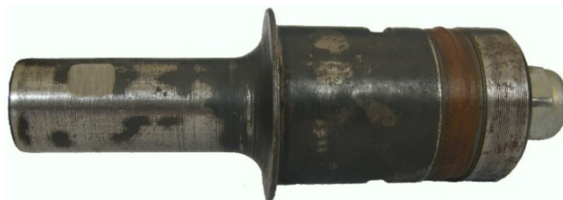
Рис. 1. 1/2-волновой преобразователь продольных колебаний
