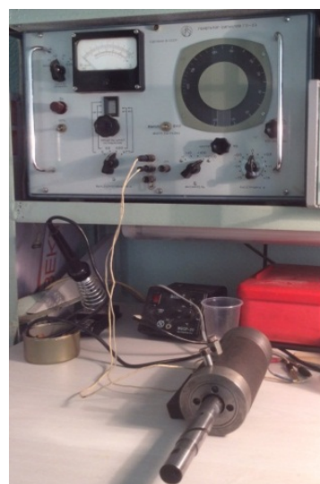
Рис. 17. Замер частоты продольных колебаний
