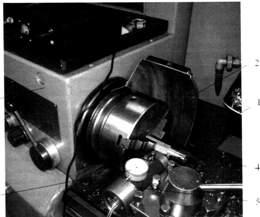
Рис. 1. Специальная установка для ультразвукового выглаживания
