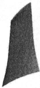
Рис. 1. Конечно-элементная модель пера рабочей лопатки
