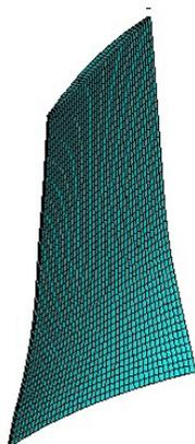
Рис. 1. Конечно-элементная модель пера рабочей лопатки
