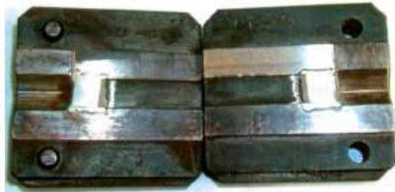
Рис. 2 Роз'ємні напівматриці для пресування заготовок робочих лопаток
