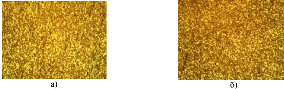
Рис. 6. Структура зон утрудненої деформації заготовки з сплаву ВТ8: а – зона I, б – зона IV
