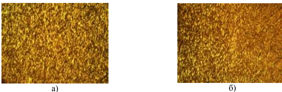
Рис. 8. Структура металу в напрямку вісі пера лопатки: а, б - різні ділянки повздовж вісі пера лопатки
