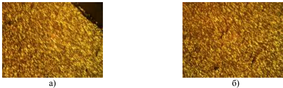
Рис. 7. Зона течії металу замкової частини заготовки до пера лопатки: а – радіусна частина галтелей зони II, б – перехідна зона (II-III) від замкової частини до пера лопатки
