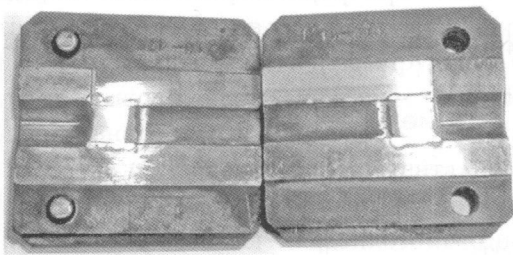
Рис. 5. Пресс (а) и разъемные полуматрицы (б) для прессования заготовок рабочих лопаток
