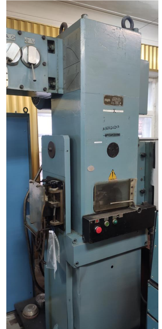
Прес для орбітального штампування зусиллям 100 т (Польща)
