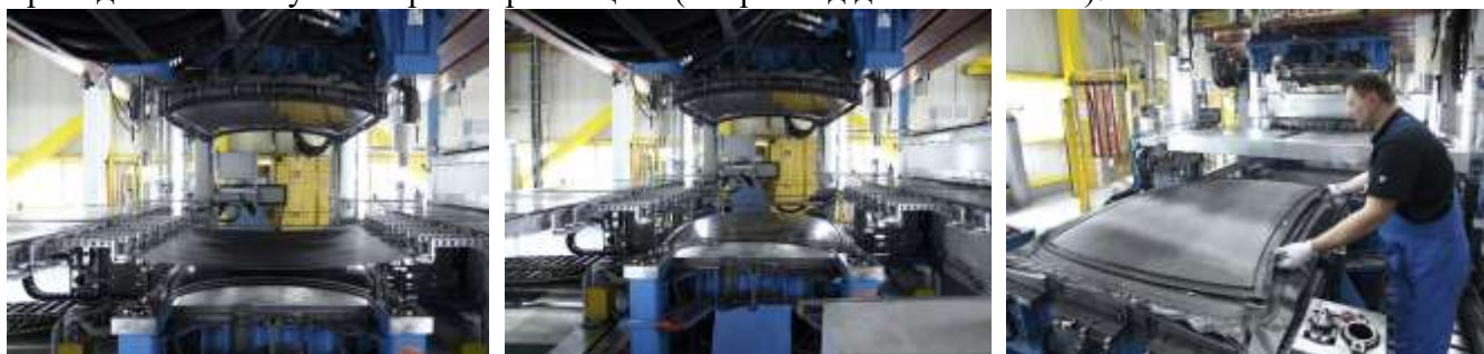
Рис. 8 Попереднє формування деталей у пресформах [6]
