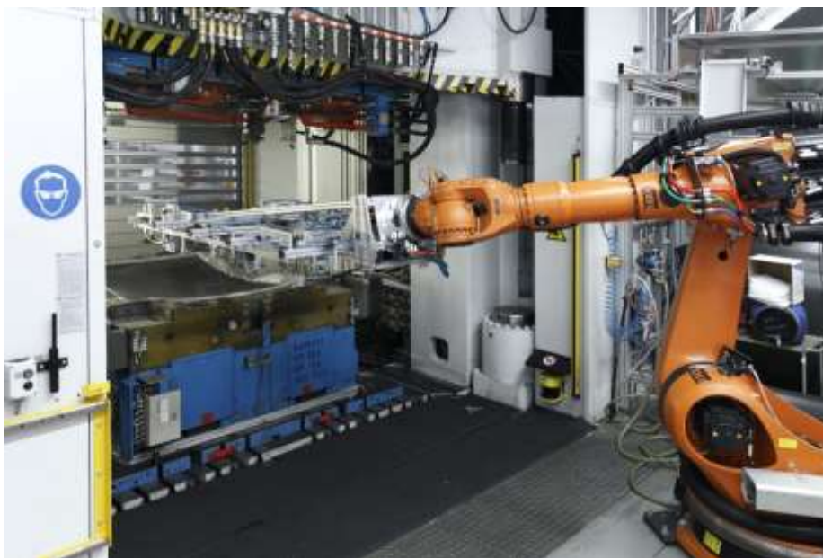
Рис 9. Переміщення преформи між процесами виробництва [6]
