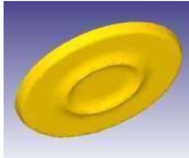
Рис.2. Напівфабрикат після штампування обкочуванням
