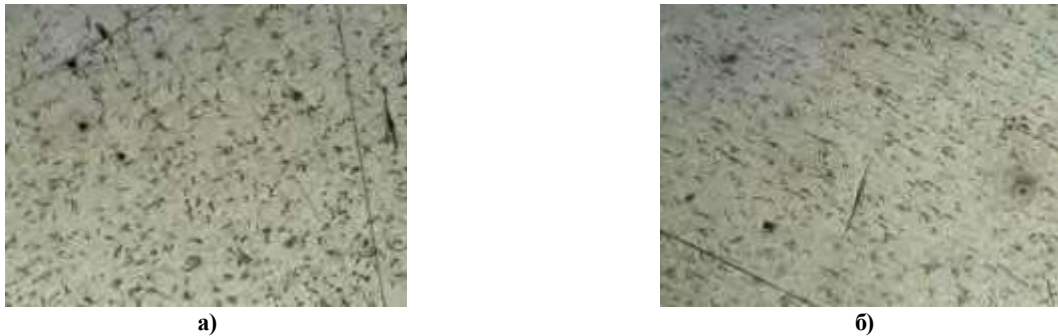
Рис. 4. Мікроструктура сталі 20 після відпалу 920С × 500: а) переріз до пластичного деформування . б) переріз після пластичного деформування
